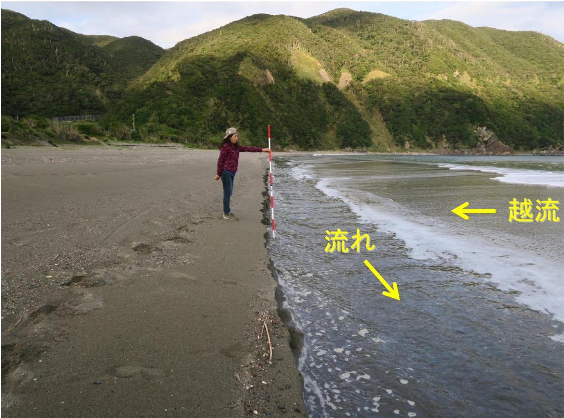
写真-24 地点 11 での砂州形成と遡上した波による戻り流れ
